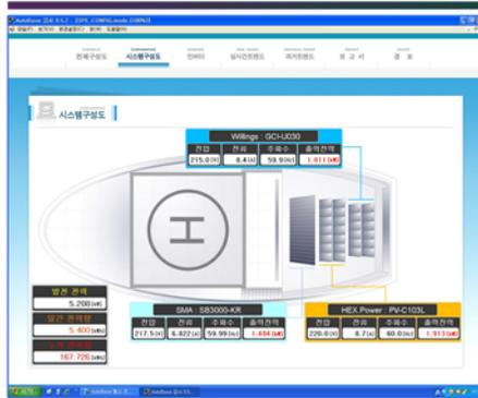
시스템 구성도는 전력 시스템의 전체 구성도를 나타내고 있을 뿐만 아니라 고압, 저압반 패널에 장착되어 있는 각각의 보호계전기의 통신상태를 화면에 나타낸다.
