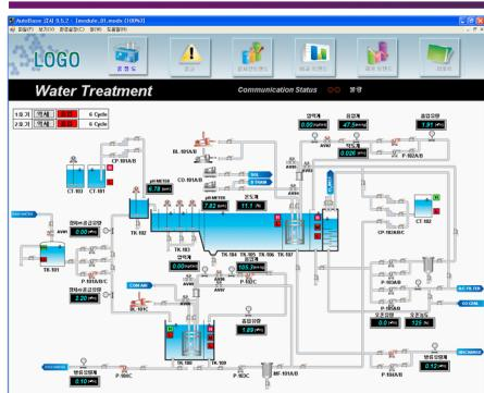
하수처리 시스템의 전반적인 공정 모니터링이 가능하며, 실시간으로 계측장비와 설비의 상태를 모니터링 한다.
